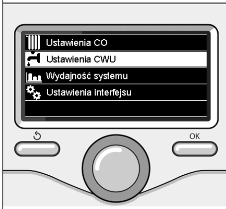
Wybór ustawień ciepłej wody
